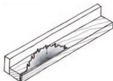
6. formatno žaganje na širino (mizni krožni žagalni stroj) 1,2
